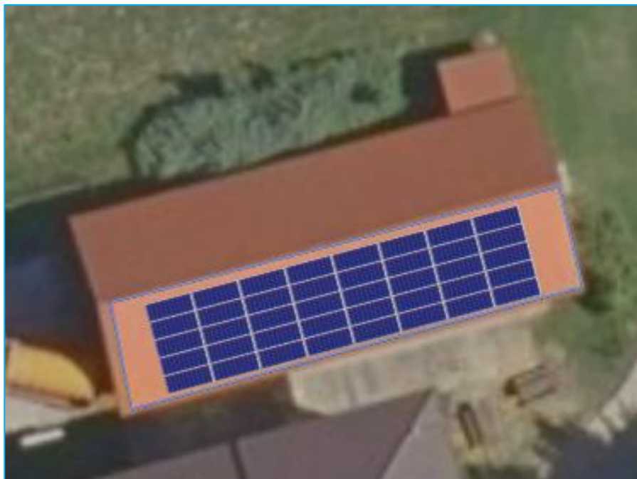
Obrázek 8 Potenciální způsob rozmístění panelů na objektu ČOV
